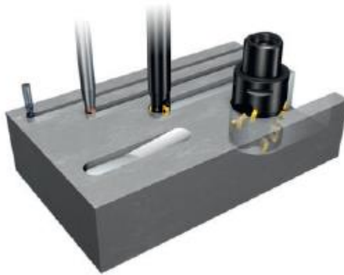
Figura 13. Ranuras rectas con fresas de mango
