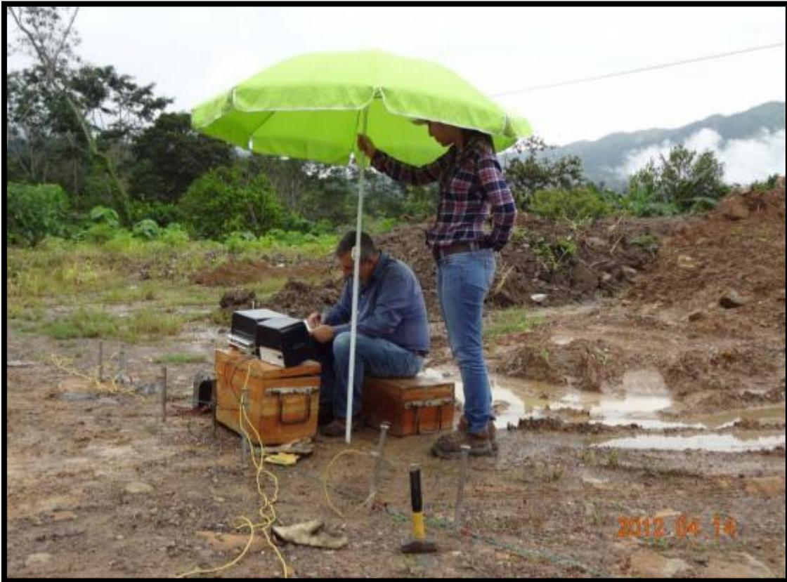
Fotografía 10. Toma de datos Sondeo Eléctrico Vertical SEV-2
