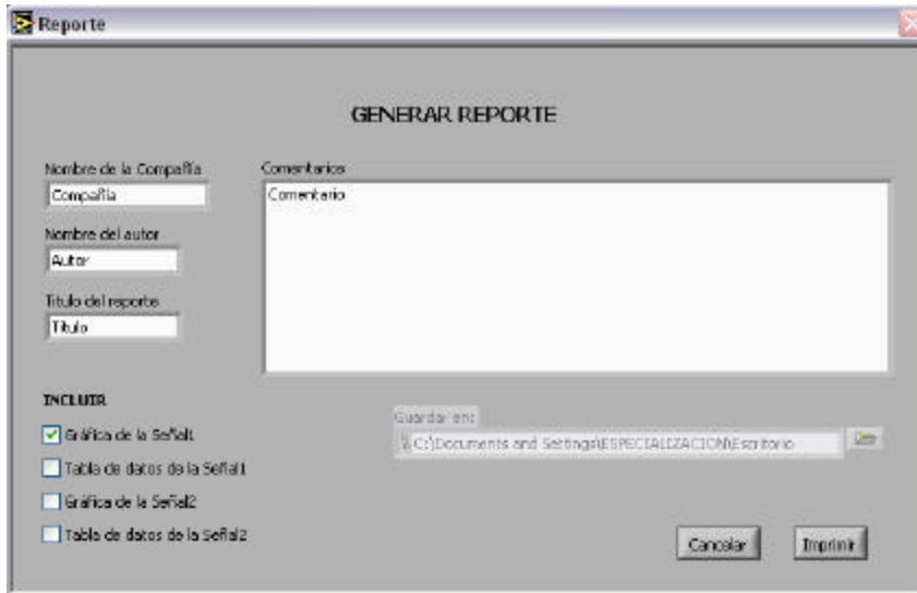
Figura 44. Panel frontal del subVI GenReporte.vi , en el cual se ingresan los datos requeridos en el reporte. El panel que se muestra en la figura corresponde al que se muestra seleccionando el ítem Imprimir del menú Reporte . El panel que se muestra cuando se selecciona el ítem HTML del menú Reporte difiere en que la herramienta para escoger la ruta se encuentra habilitada.
