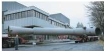
Eyector de un sistema de vacío de 4 etapas para la desgasificación del acero. Caudal de aspiración: 2.100 kg/h @ 2.387.000 m 3 /h, presión abs. de aspiración: 0,6 mbar
