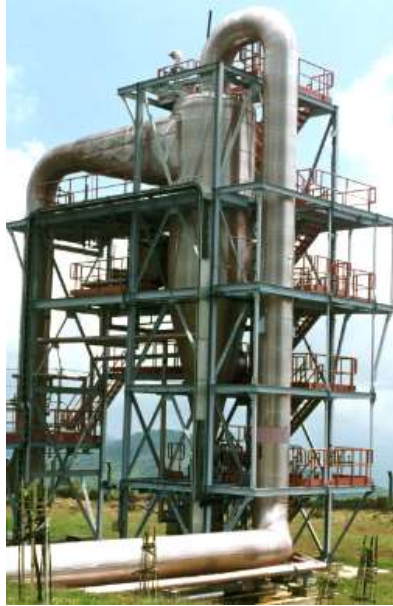
Figura 32. Separador ciclónico Vortex AIROL
