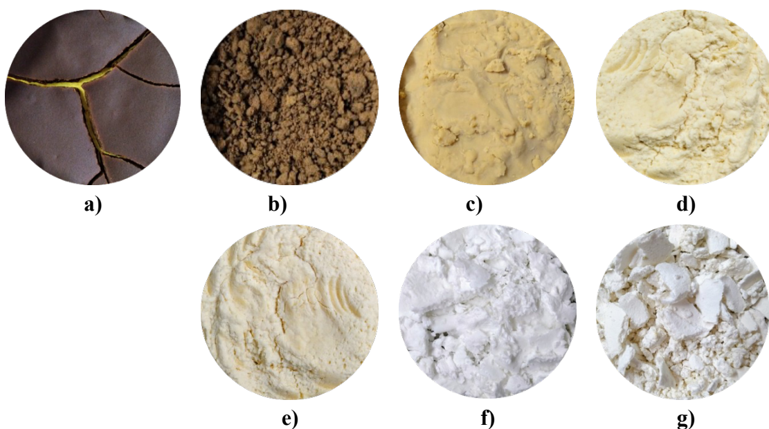
Figura 12. Evolución de la extracción y producción de celulosa: a) Con tratamiento alcalino, b) Secado tras tratamiento alcalino, c) - f) Primera y última etapa de blanqueo, g) Celulosa obtenida.
