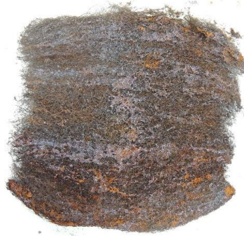
Figura 8. Cupones de lana de acero oxidados usando diferentes ácidos.
