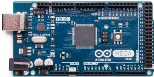
Figura 6. Tarjeta Arduino® Mega 2560.
