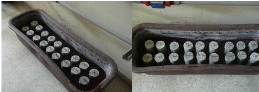
Figura 11. Probetas en etapa de humectación y secado en solución salina de NaCl al 3%.
