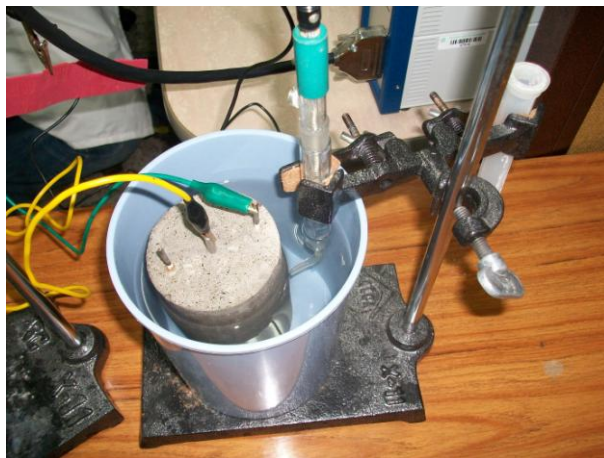
Figura 15. Montaje de la celda electroquímica en el Laboratorio.
