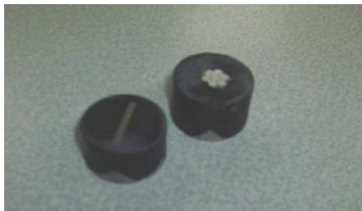
Figura 12. Descripción del montaje de las probetas para análisis metalográfico (Sección longitudinal y Transversal).
