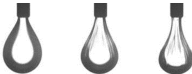
Figura 26. Deformación de membrana de GO en interfase agua-aceite. (S. Fang, Chen, Wang, et al., 2016)
