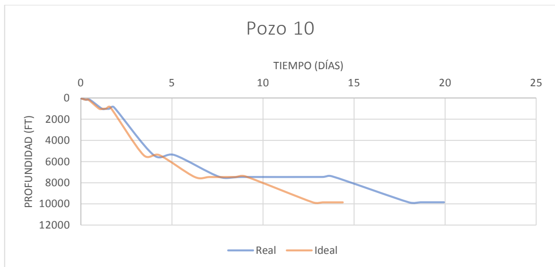
Figura 29 Profundidad vs Tiempo ideal y real a partir de la relación promedio, para el pozo 10.
