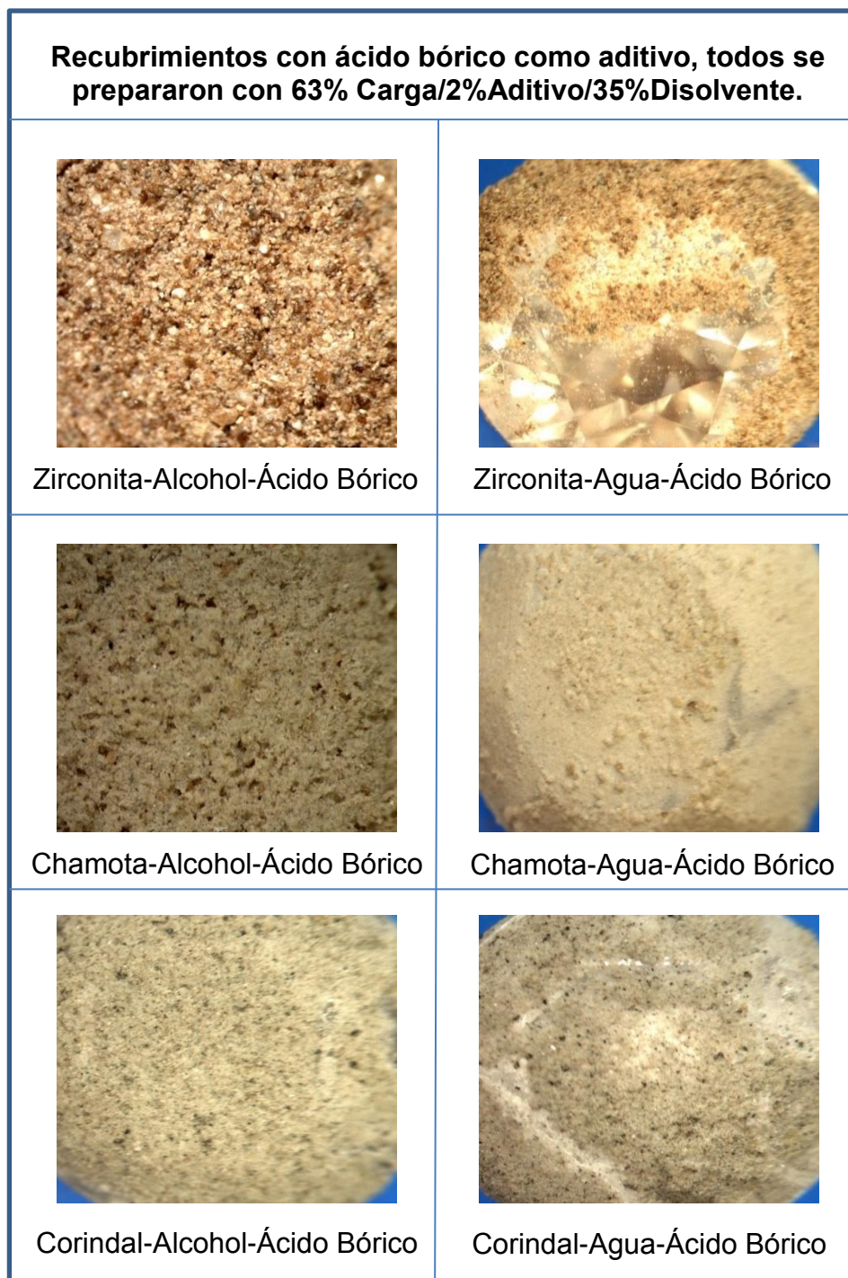
Figura 9. Zircones recubiertos con zirconita, chamota, corindal y ácido bórico (aditivo) como carga sólida y alcohol o agua como carga líquida, misma relación sól/líq. Fotografías a 0.67X.
