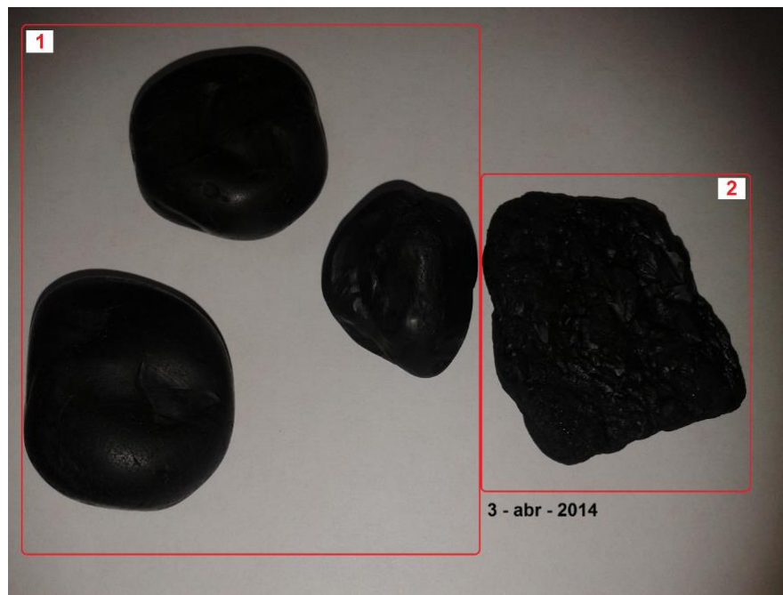
Figura 14. Coque en filtros de las P-4203 A/B - ID 200976969 (unidad UOP II)
