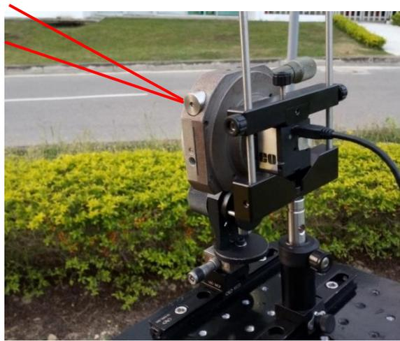
*Figura 23.* Configuración de la cámara para medidas de distancia.
