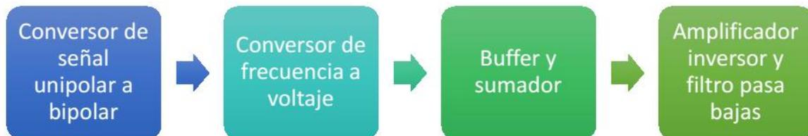
Figura 51. Diagrama de comunicación del sensor de humedad relativa. Fuente: (Herreño Vanegas & Villamizar Conde, 2016)
