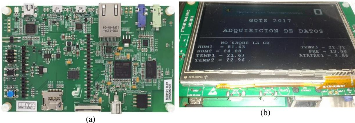
Figura 39. (a) Sistema de desarrollo utilizado. Fuente: (STMicroelectronics, 2015). (b) Software implementado para pruebas.
