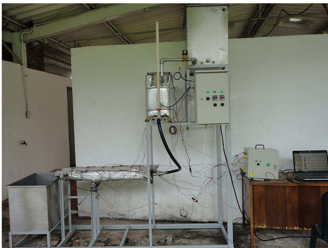
Figura 8. Evaporador de película en placa plana a escala piloto.
