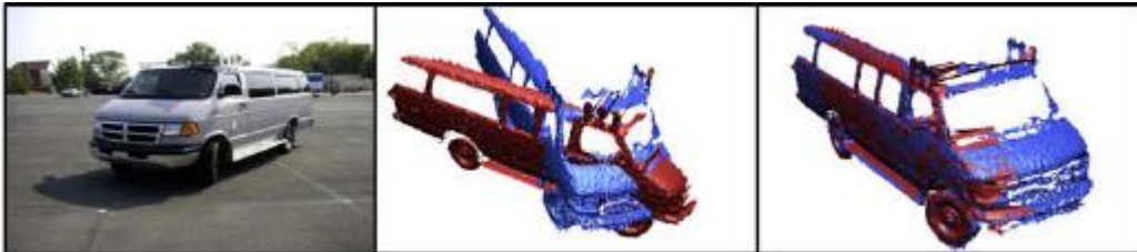
Figura 29. Registro de dos nubes de puntos por el método de campos Gaussianos.
