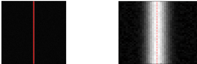
Figura 12. Extracción del centro geométrico de la línea proyectada.
