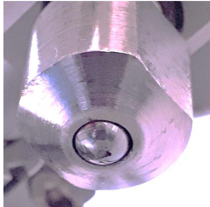
Figura 13. Superficie de esfera de Carburo de Tungsteno.
