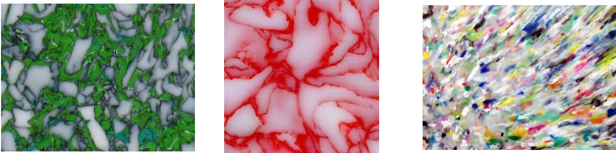
Imagen 13 Ejemplos de acabado directo de inyección o calandrado 82
