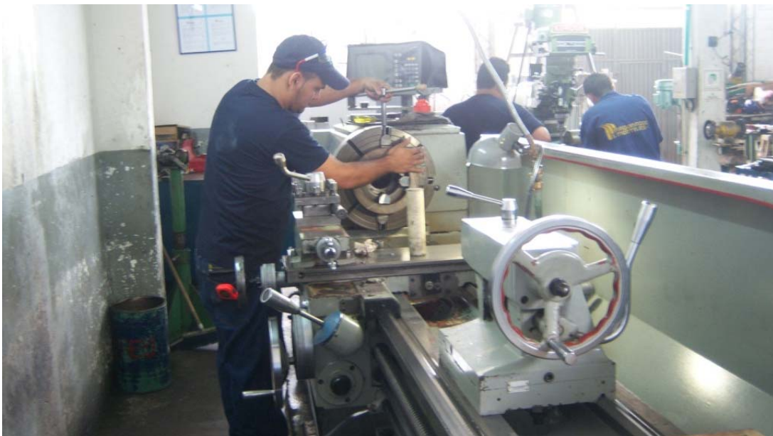
Figura 27b. Fabricación de horquilla para caja principal de Torno DMTG
