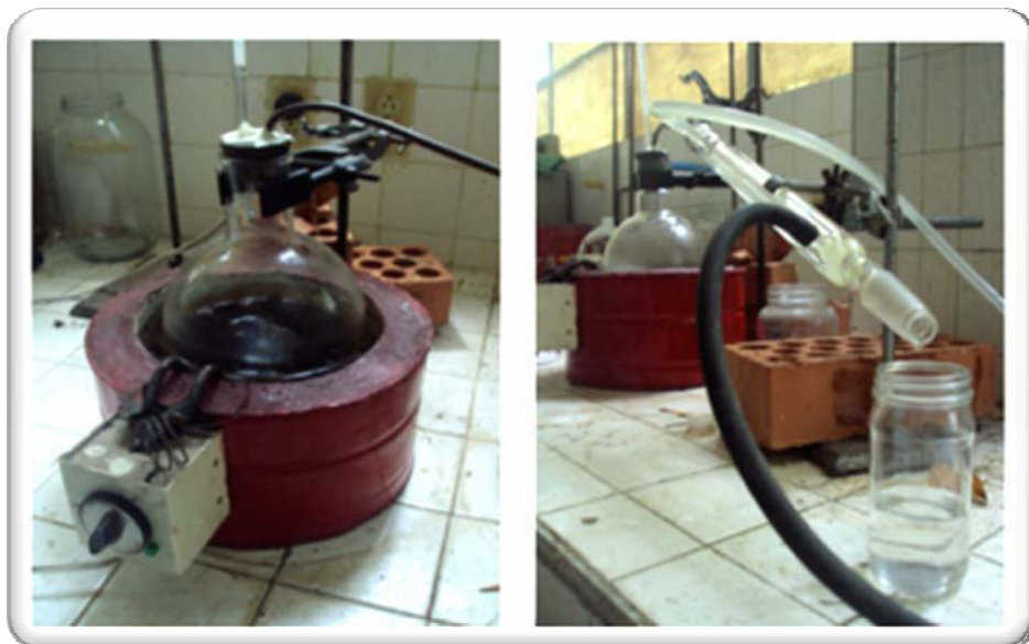
Figura 63. Montaje de Destilación simple utilizado para cada extracto
