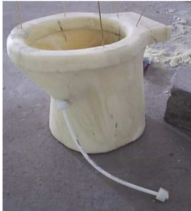
FIGURA 75. PRIMER MODELO SEPARADOR DE ORINA.
