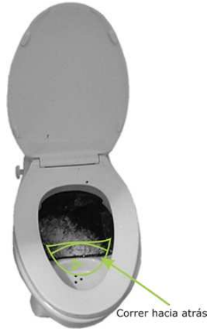
FIGURA 81. MODIFICACIÓN A REALIZARLE AL SEPARADOR DE ORINA
