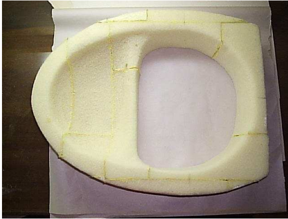
FIGURA 77. FASES DE CONSTRUCCIÓN SEPARADOR DE ORINA
