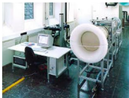
Figura 14. Instalación de circuito abierto
