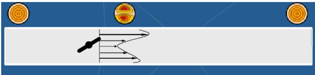
Figura 5. Variación del perfil de velocidades aguas abajo por asimetría [2]
