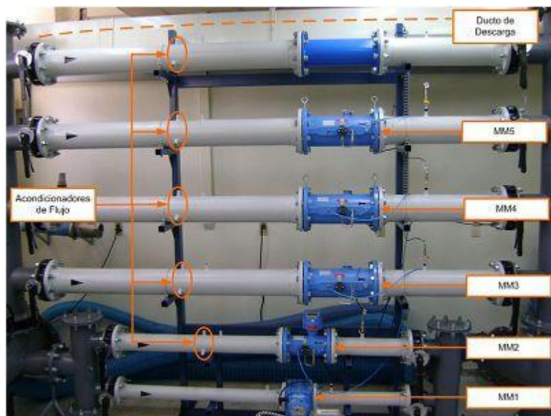
Figura 23. Patrón de referencia del Banco de Alto Caudal
