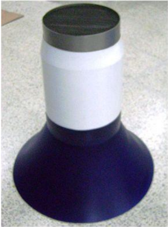
Figura 52. Ensamble del rectificador con la Sección de Entrada.
