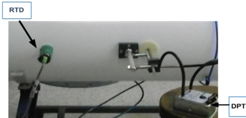
Figura 29. RTD Y DPT de la sección de pruebas.
