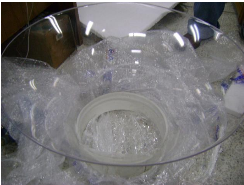
Figura 49. Contracción en Acrílico.
