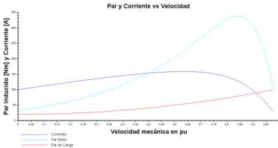
Figura 20. Corriente Vs Velocidad y Par Vs Velocidad para un arranque suave
