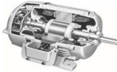
Figura 2. Diagrama de corte de un motor jaula de ardilla. Recuperado de Chapman, S. J. Máquinas eléctricas. Quinta edición, Mc Graw Hill; 2016
