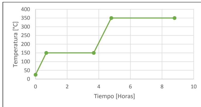
Figura 6. Tratamiento térmico aplicado a los revestimientos.
