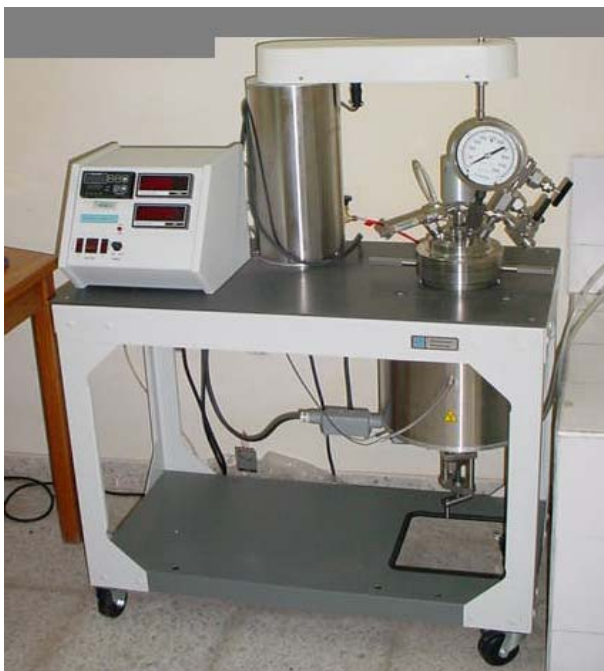
Fotografía 7. Autoclave estático del G.I.C. para pruebas de gravimetría.
