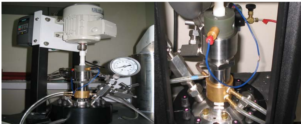
Fotografía 10. Montaje de Autoclave dinámica con ECR. Detalles de los puertos para medidas electroquímicas.
