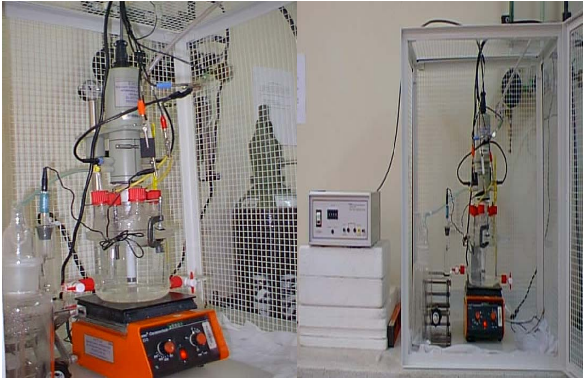
Fotografía 3. Montaje Celda del ECR.
