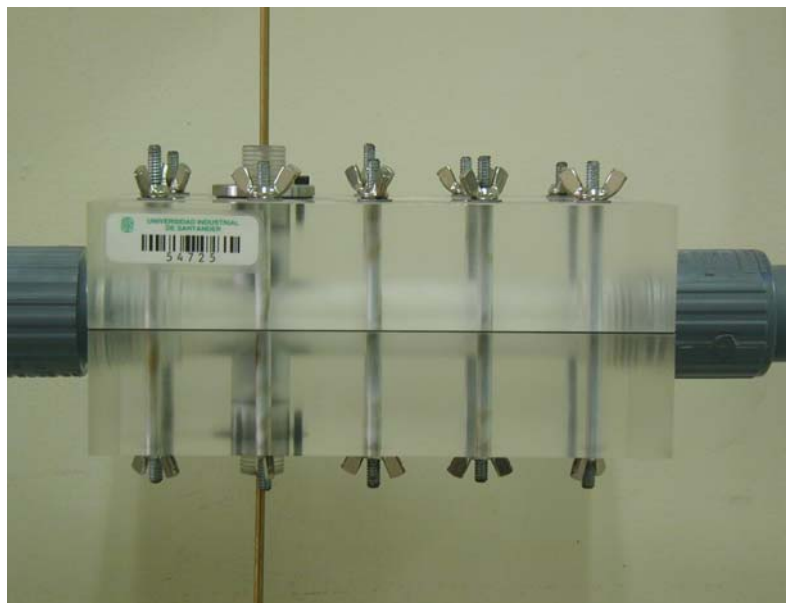
Fotografía 5. Celda electroquímica de electrodo largo para evaluación de coeficientes de transferencia de masa completamente desarrollada en el LOOP
