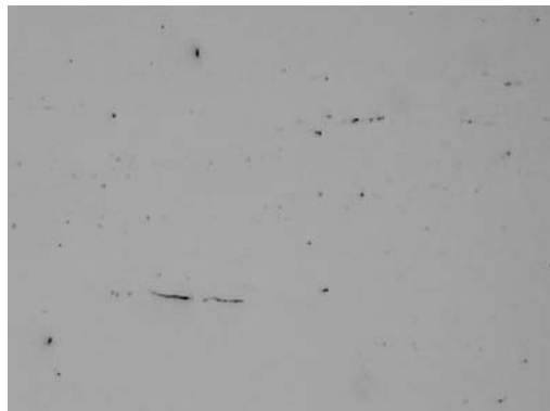
Fotografía 1. Inclusiones no metálicas de sulfuros serie fina y gruesa y óxidos globulares serie fina. Sin ataque químico, 100X.
