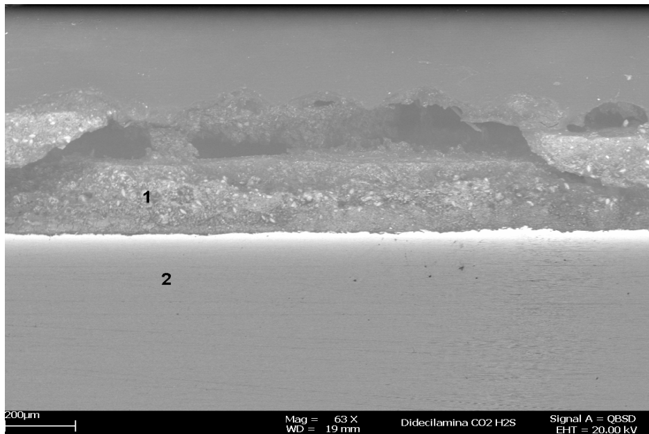
Fotografía 19. Micrografía de la Interfaz cupón de Acero AISI-SAE 1020 / Salmuera / Didecilamina, 10 ppm, a 59°C y 700 psi.
