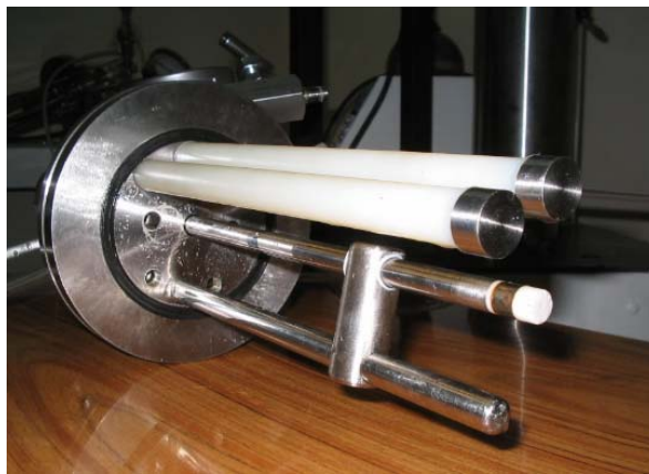
Fotografía 9. Arreglo de electrodos para pruebas electroquímicas en autoclave dinámica.
