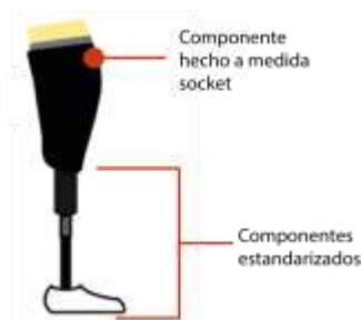
Figura 4 Componentes estandarizados y a medida de la prótesis, tomado de (Paternò et al., 2018).
