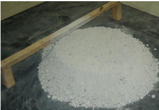
Extensión del material con regla
