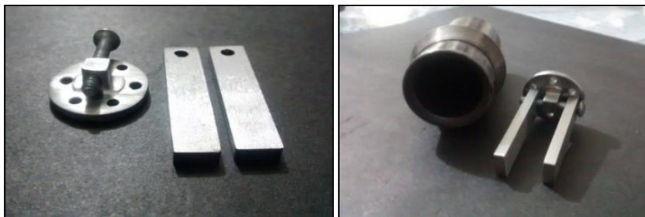
Figura 3. Montaje experimental de los cupones gravimétricos en el reactor.
