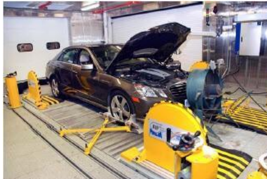
Figura 3. Prueba de emisiones en vehículos ligeros [7].
