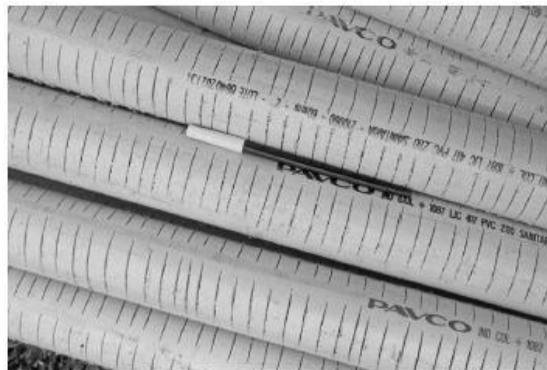
Figura 6. Drenes en PVC ranurados en obra [5]
