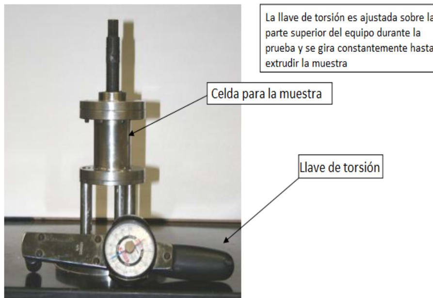
Figura 37. Probador de la dureza bulk de formaciones arcillosas
