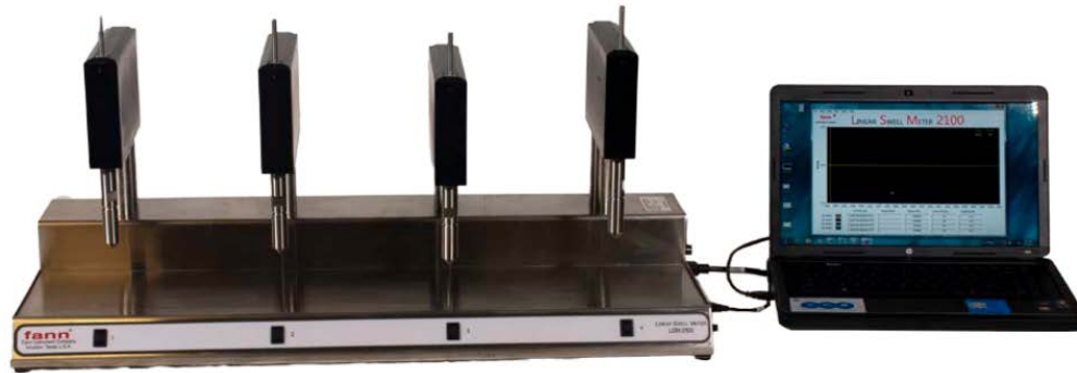
Figura 33. Equipo de hinchamiento lineal
