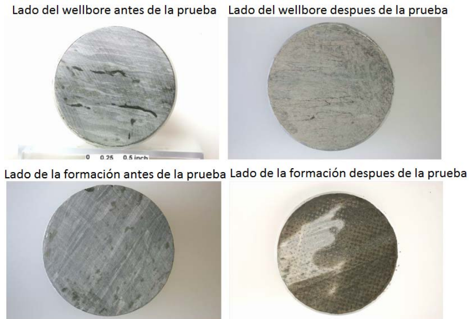
Figura 27. Lados del plug mostrando el desarrollo de fracturas antes y después de la confinación de la muestra
