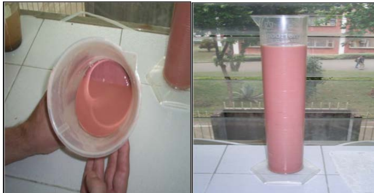
Figura 10. Separación y traslado de la fracción arcillosa
