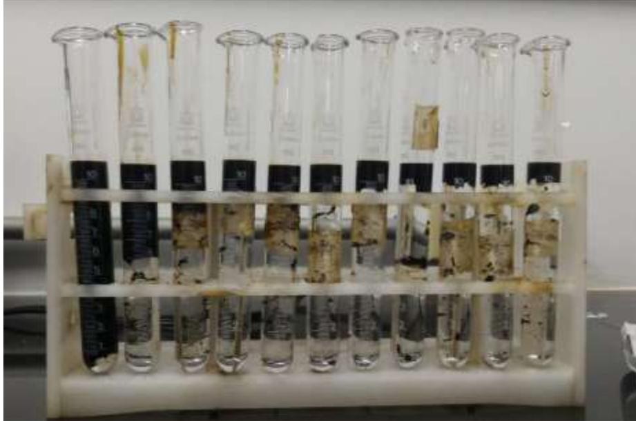
**Figura F-8.** Efluentes obtenidos luego de inyección de surfactante, experimento número 4: Inyección de 0.3 VP y 1.5 % de surfactante en medio poroso mojado al aceite.
