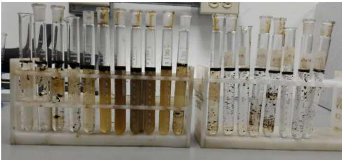
**Figura F-5.** Efluentes obtenidos luego de inyección de agua, experimento número 3: Inyección de 0.3 VP y 1.5 % de surfactante en medio poroso mojado al agua.
