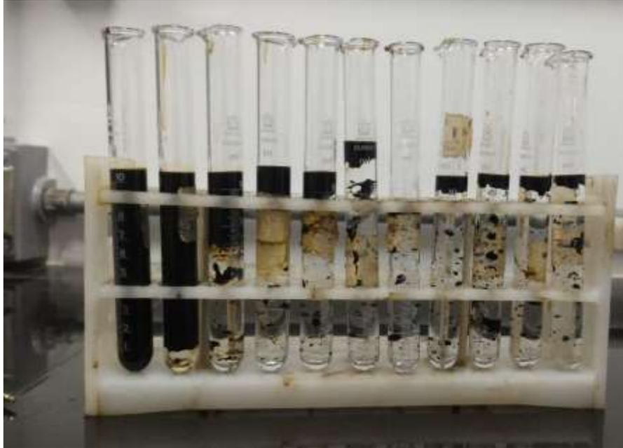
**Figura F-6.** Efluentes obtenidos luego de inyección de surfactante, experimento número 3: Inyección de 0.3 VP y 1.5 % de surfactante en medio poroso mojado al agua.
