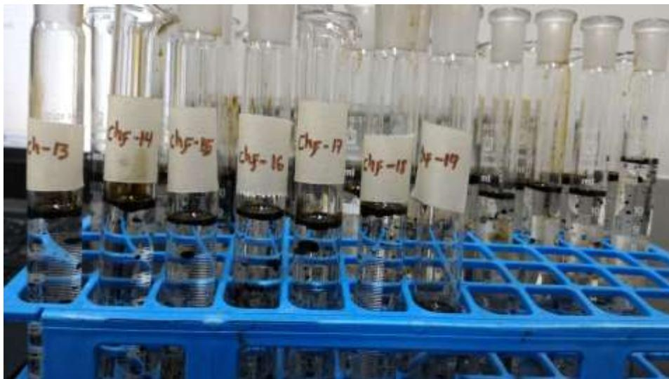
**Figura F-3.** Efluentes obtenidos luego de inyección de agua, experimento número 2: Inyección de 0.3 VP y 0.5 % de surfactante en medio poroso mojado al aceite.
