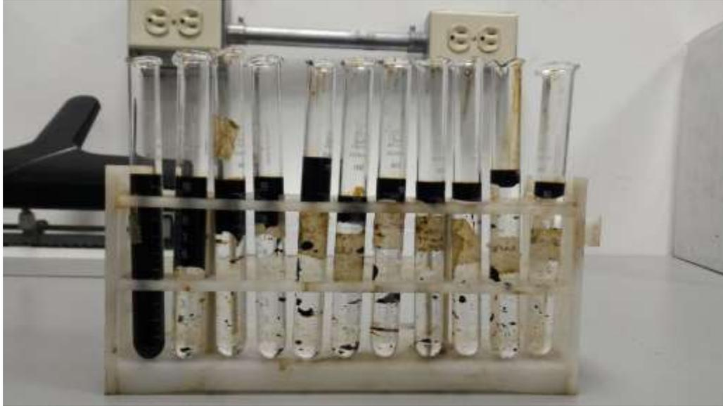
**Figura F-4.** Efluentes obtenidos luego de inyección de surfactante, experimento número 2: Inyección de 0.3 VP y 0.5 % de surfactante en medio poroso mojado al aceite.
