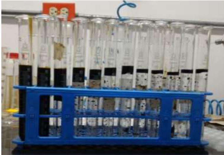
**Figura F-2.** Efluentes obtenidos luego de inyección de surfactante, experimento número 1: Inyección de 0.3 VP y 0.5 % de surfactante en medio poroso mojado al agua.
