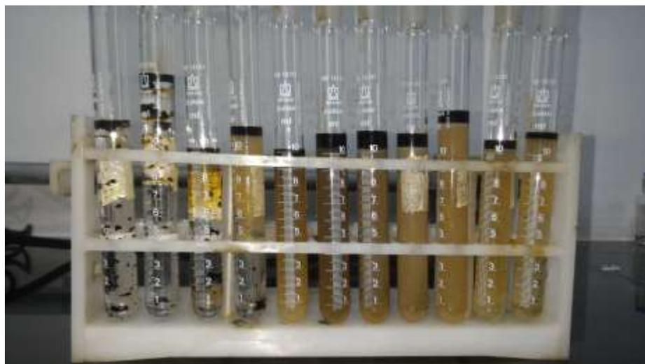
**Figura F-9.** Efluentes obtenidos luego de inyección de surfactante, experimento número 5 y 6: Inyección de 1 VP y 0.15 % de surfactante en medio poroso mojado al agua y aceite.
