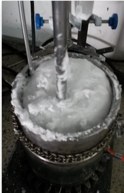
Figura 11. Ensayo 5: Síntesis de estearato de calcio por doble descomposición.
