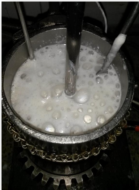
Figura 9. Ensayo 3: Adición de Hidróxido de Calcio en Exceso.
