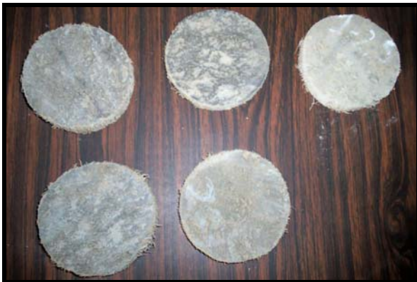
Figura 14. Probetas empleadas en el ensayo de evaluación acústica
