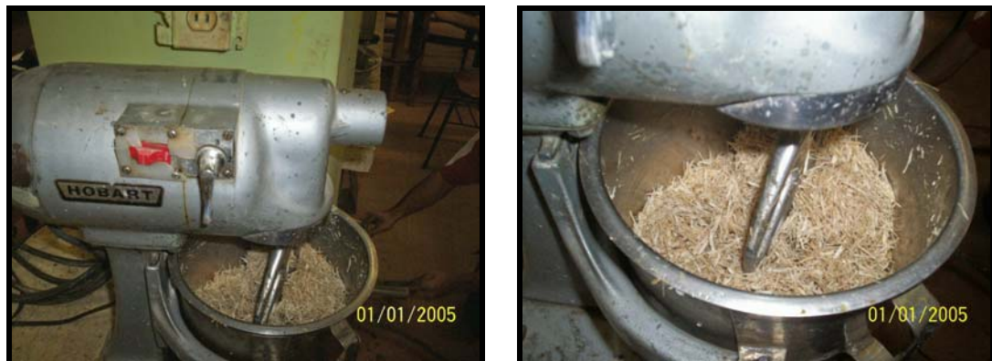
Figura 5. Mezcladora mecánica. Laboratorio de Ingeniería Civil
