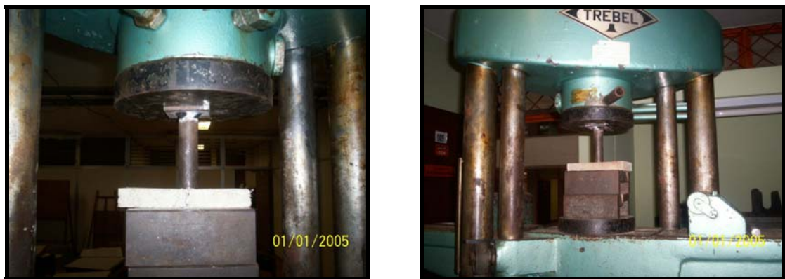
Figura 11. Ensayos de penetración.
