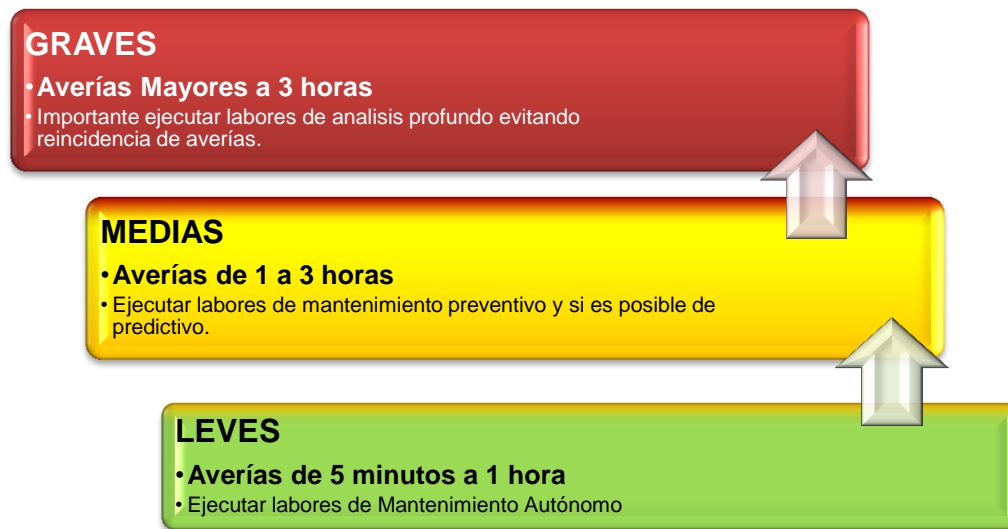
Figura 52: Diagrama de clasificación de averías para los equipos principales.
