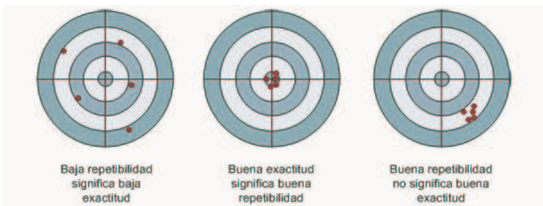
Figura A.1 Diferencia entre exactitud y repetibilidad
