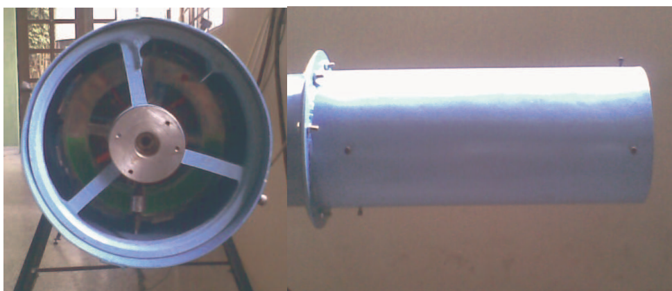
Figura 22. Medidor de velocidad de aire construido
