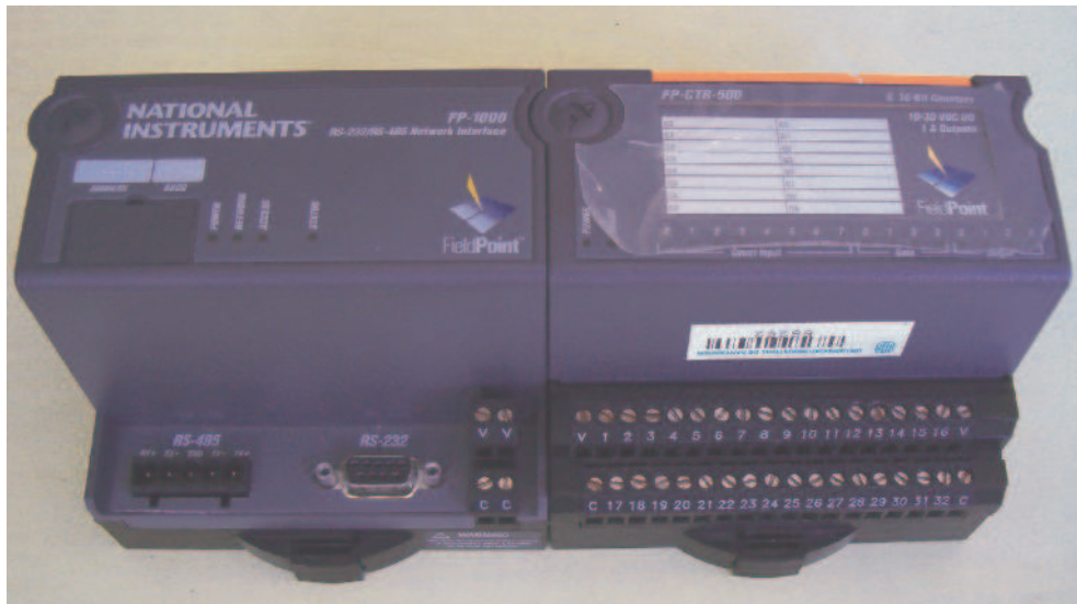
Figura 61. Field Point y modulo de contadores
