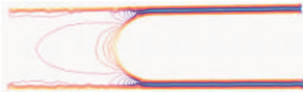
Patrón de flujo debido al cuerpo semiesférico
