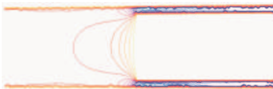
Patrón de flujo sin el cuerpo semiesférico
