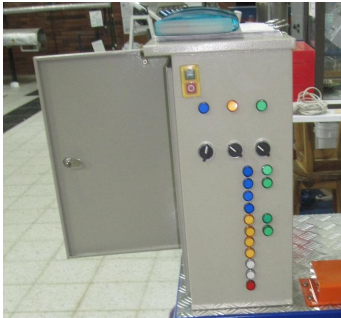
Figura 49. Disposición de las luces y selectores en el tablero de control.
