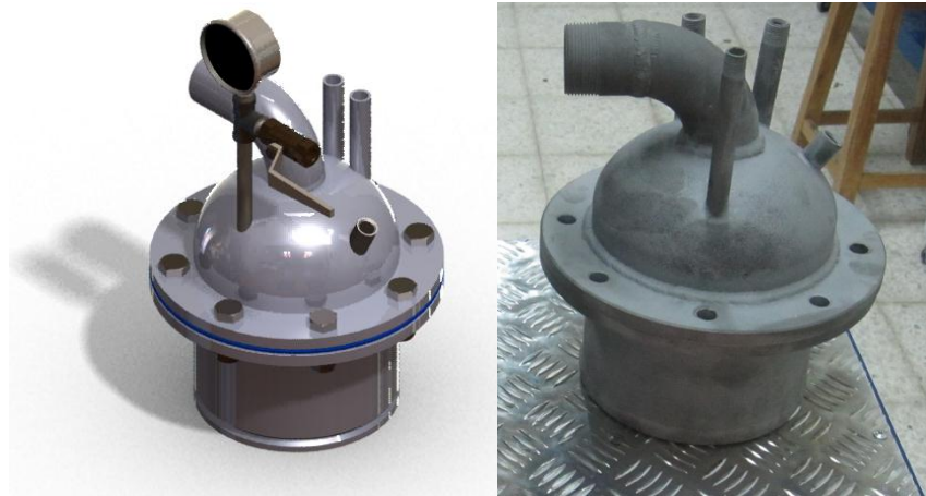
Figura 40. Diseño y terminación del tanque evaporador/condensador.
