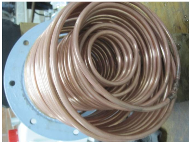
Figura 43. Terminación del serpentín del tanque absorbedor/generador.
