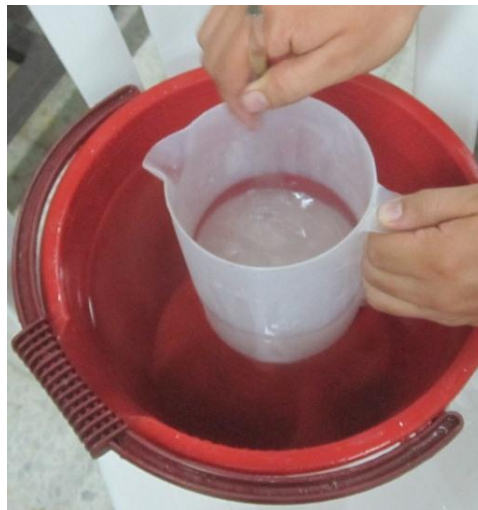
Figura 61. Disipación de calor de disolución en la elaboración de la solución.
