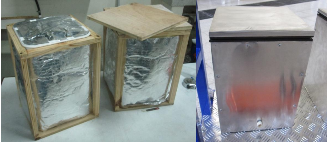
Figura 46. Etapas de construcción de los tanques de proceso intermedio.
