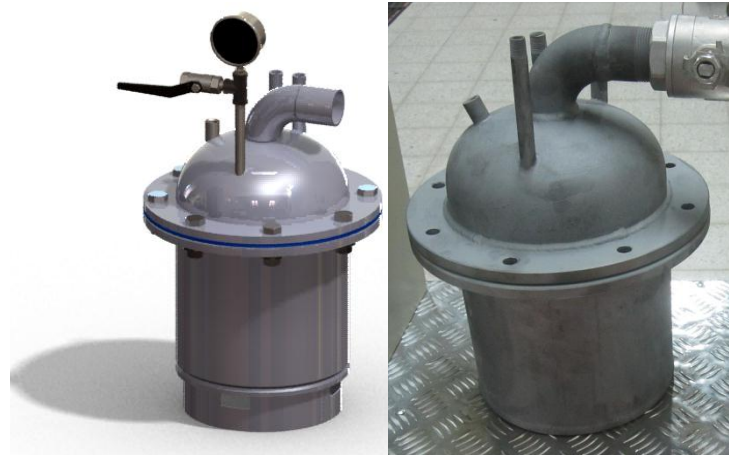
Figura 42. Diseño y terminación del tanque absorbedor/generador.
