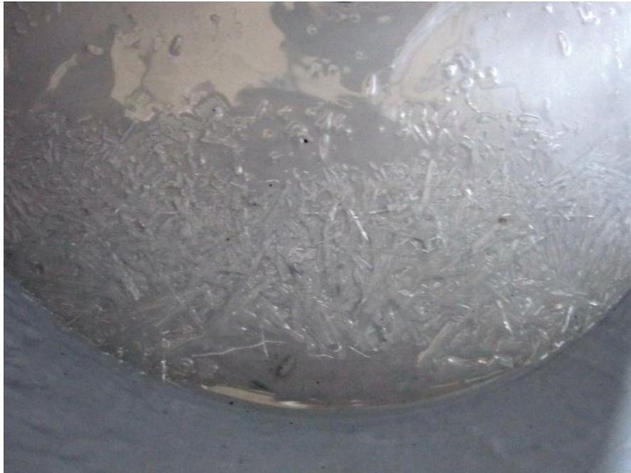
Figura 68. Cristalización de la solución en el absorbedor.
