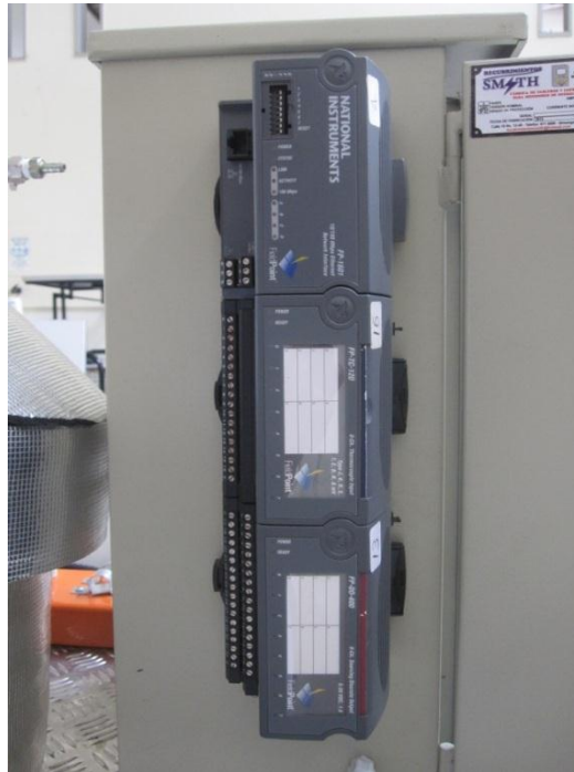
Figura 55. Disposición de los módulos del Field point en el prototipo.
