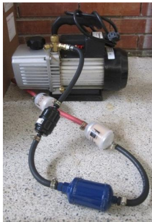
Figura 56. Montaje del sistema de purga y los filtros.
