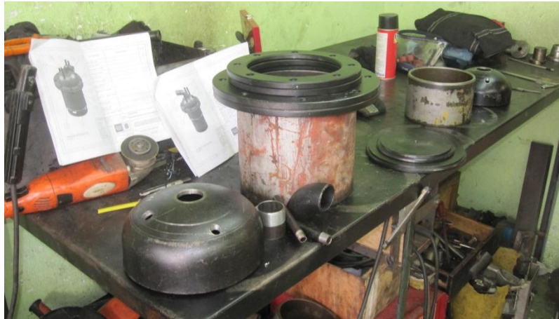
Figura 39. Final de los mecanizados de los tanques de proceso principal.
