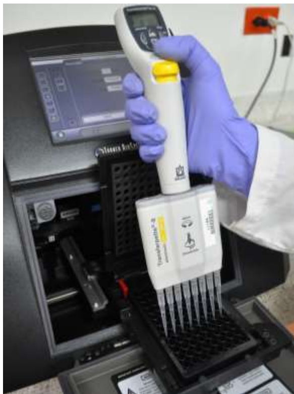
Figura 19. Lector de microplacas Turner Biosystems Inc. Modulus TM II Microplate Multimode Reader. CENIVAM, UIS. Laboratorio J. J. Thomson. Bucaramanga, 17 de enero de 2017.
