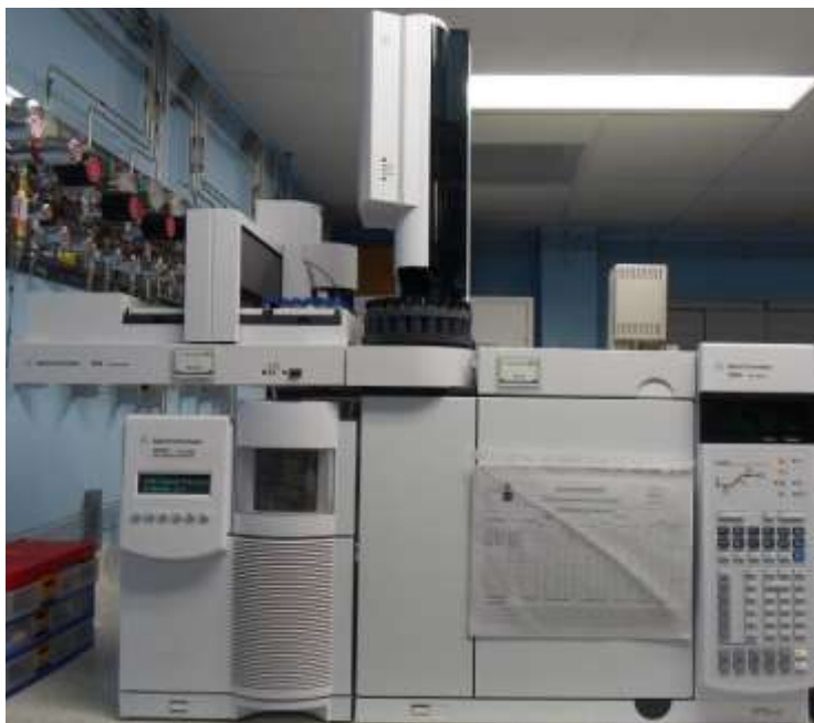
Figura 17. Cromatógrafo de gases AT 6890 Plus acoplado a un detector selectivo de masas AT MSD 5973 Network. Fuente: Laboratorio de Instrumentación Analítica CROM-MASS. UIS, Bucaramanga, 9 de septiembre de 2015.
