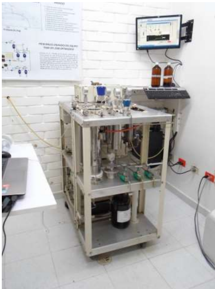
Figura 16. Equipo de extracción con fluido supercrítico: Thar SFE-2000-2-FMC50 . CENIVAM. UIS. Bucaramanga, 31 de octubre de 2017.
