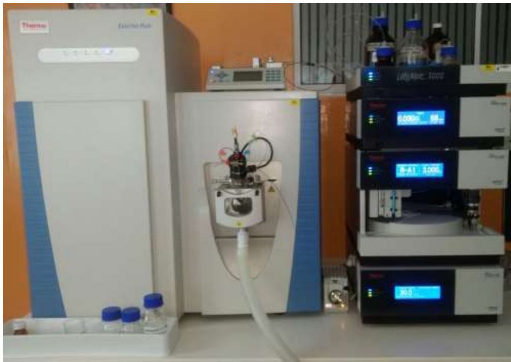
Figura 18. Cromatógrafo líquido UHPLC Dionex UltiMate 3000 , acoplado a espectrómetro de masas Orbitrap Exactive Plus , con interfaz de electronebulización. CENIVAM, Laboratorio Alexander Makarov. UIS. Bucaramanga, 12 de junio de 2017.
