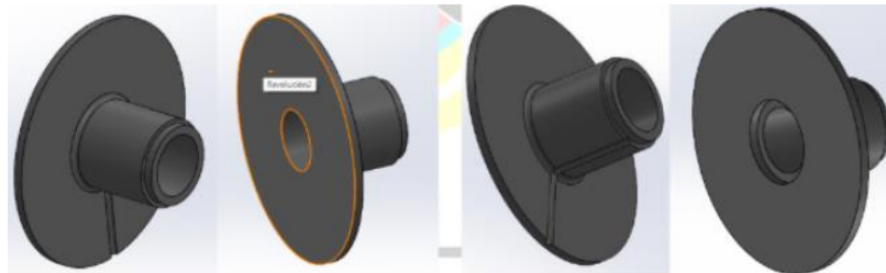
Figura D2. Secciones individuales para construcción de carrete
