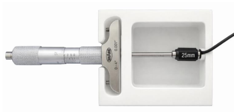
Figura C1. Configuración experimental para medición de velocidad del sonido.
