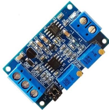
Figura 17. Módulo Convertidor De Señal Corriente A Voltaje 4-20ma A 0-10V.
