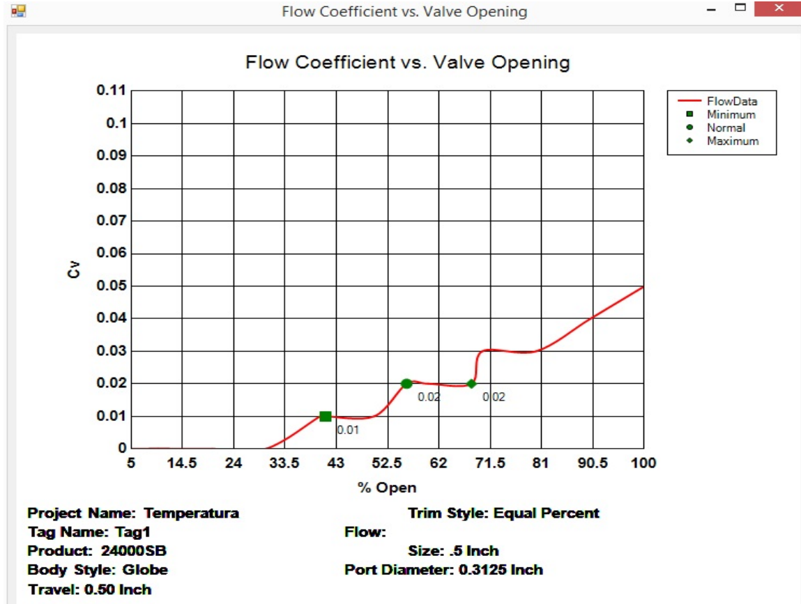
FIGURA G. Datos del Cv arrojados por el programa para el diseño de la válvula de control de temperatura
