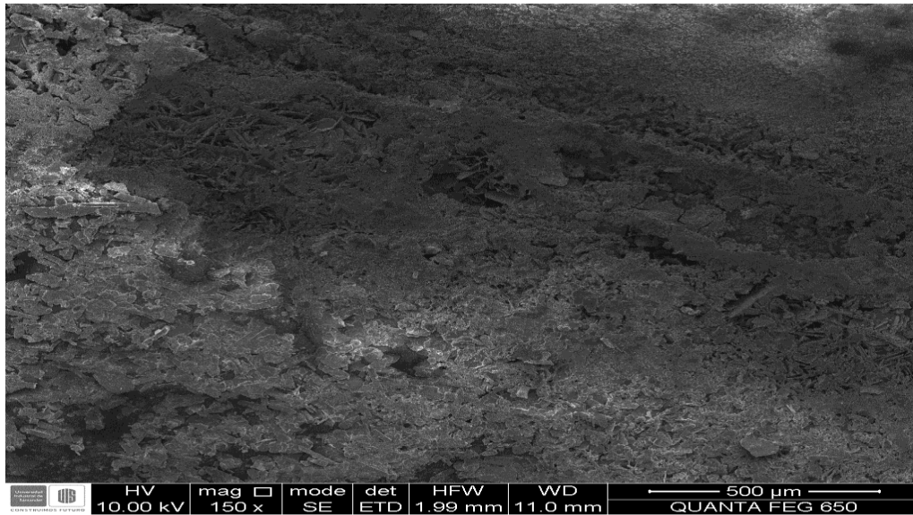
Figura E-3. Micrografía superficial de lámina galvanizada y pintada - SEM a condiciones de lámina normal en concentraciones altas expuestas en cámara salina durante 16 y 32 días. Magnificación 2000 X.
