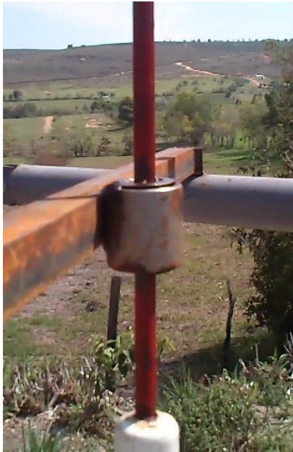
Figura 71. Guías para la varilla oscilante
