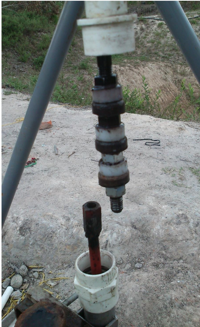
Figura 70. Triple sello en la unión Bomba-Varilla
