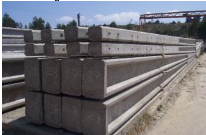
Figura 24. Postes de hormigón armado
