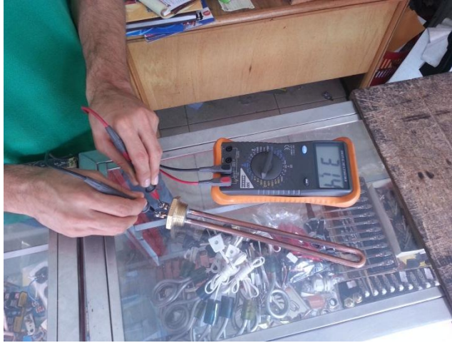
Figura 180. Resistencia de 1500 W. resistencia en ohm
