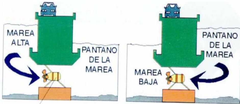
Figura 6. Esquema de una central Mareomotriz
