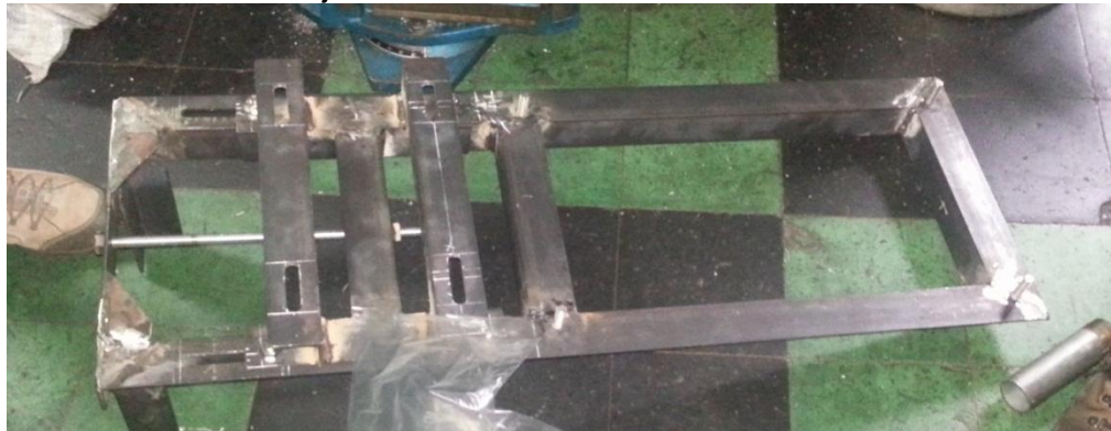
Figura 156. Bastidor conjunto Turbina-Generador
