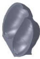
ISOMETRICO CUCHARA PELTON
