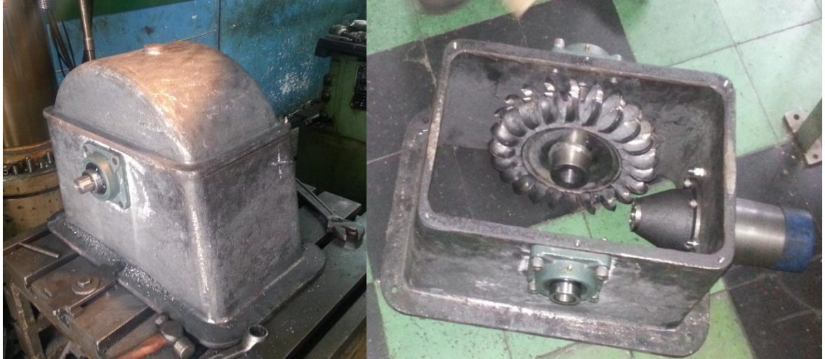
Figura 157. Ensamble de piezas de la turbina
