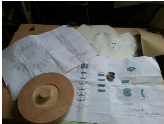
Figura 144. Modelos del rodete en madera
