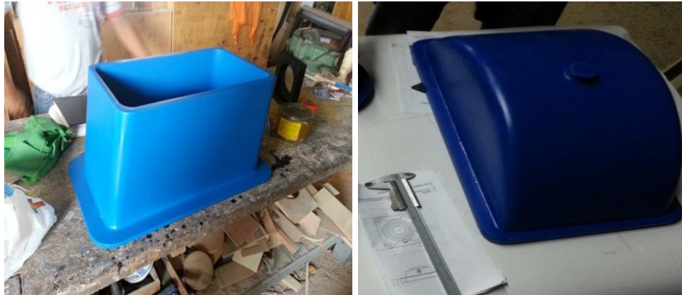
Figura 147. Modelos de la carcasa en madera
