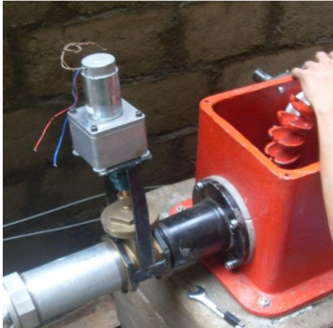
Figura 159. Ensamble válvula + moto-reductor
