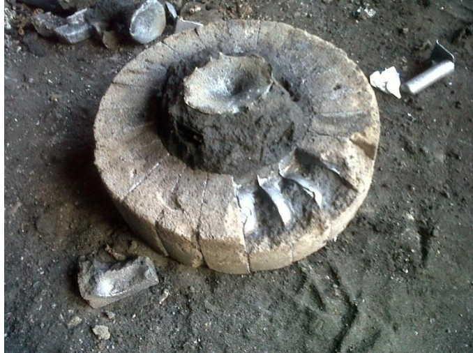
Figura 150. Fundición del rodete
