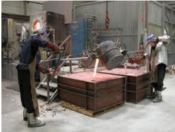
Figura 51. Fundición en arena
