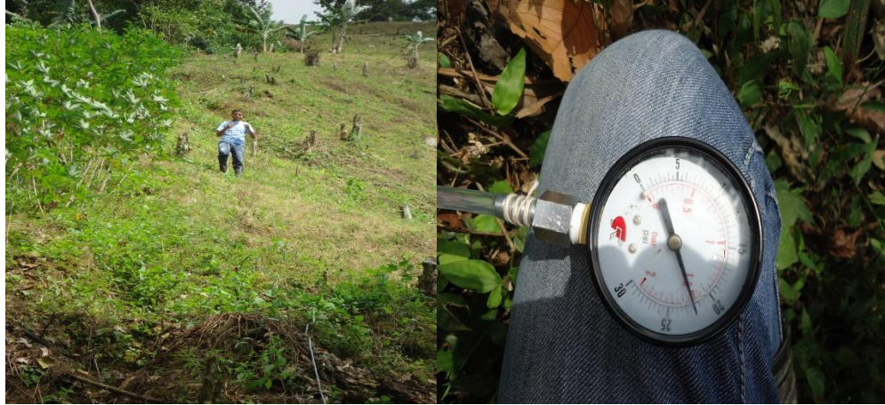
Figura 47. Medición del salto finca Mirasol
