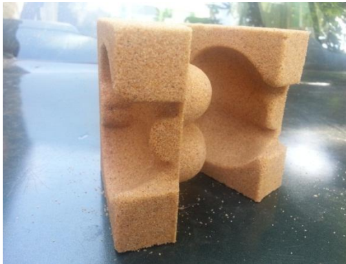
Figura 146. Machos en arena sílica con bentonita
