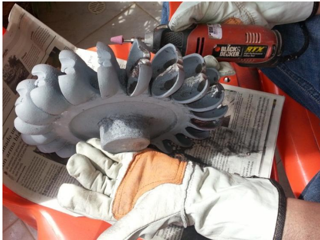
Figura 155. Pulido de las cucharas del rodete
