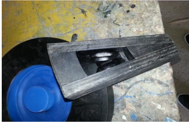
Figura 145. Caja de machos en madera
