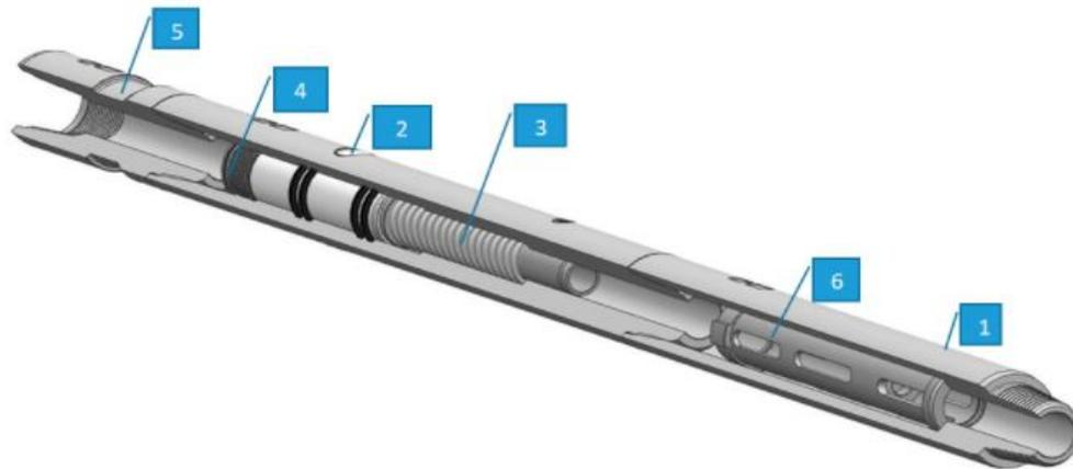
*Nota.* El Circulating Sub consta de una caja (1) con dos puertos, un pistón (2); un resorte (3); una manga de asiento de bola (4); un adaptador de elevador (5) y el captador de bolas (6). Tomado de *Drilling Equipment Service Company*, <https://bit.ly/2Pz5ANS>
