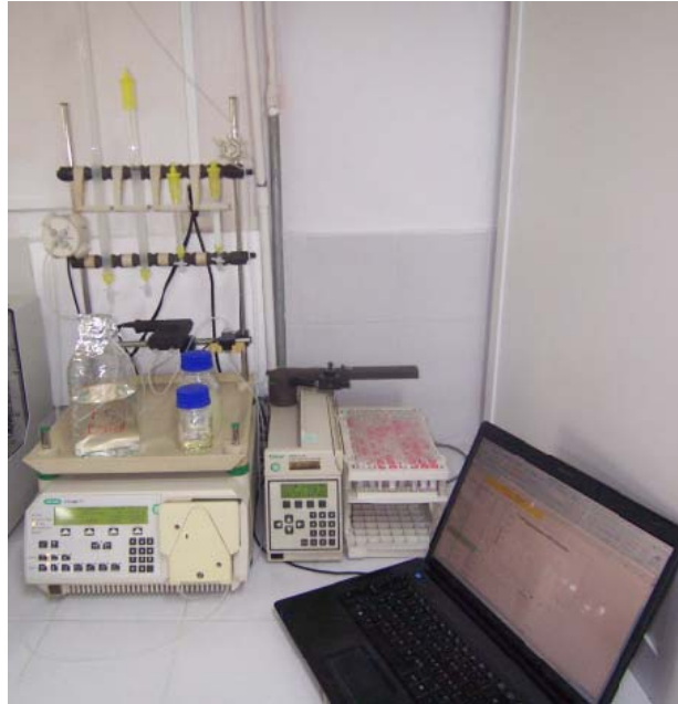
Figura 7. Cromatógrafo líquido de baja presión (Biologic LP, Biorad), con las columnas empacadas, el colector de fracciones y el computador externo usado para graficar los cromatogramas.
