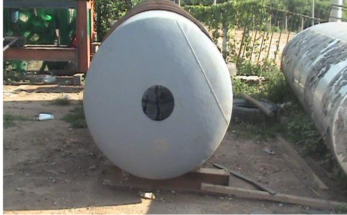
Figura 71. Tapa de carga soldada
