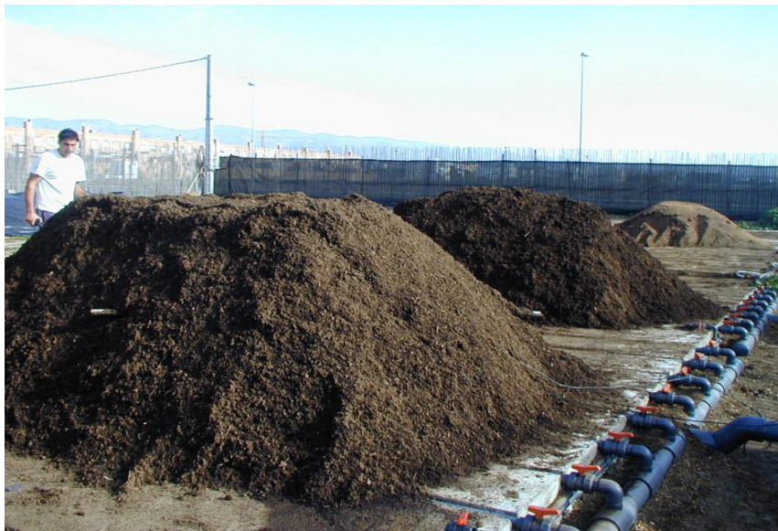
Figura 10. Pilas de volteo con aireación positiva. Fuente Internet: gestionintegralresiduos.blogspot.com .
