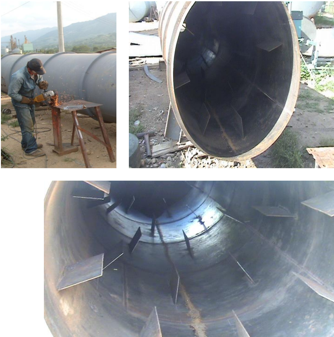
Figura 79. Sistema de aspas internas del tanque.
