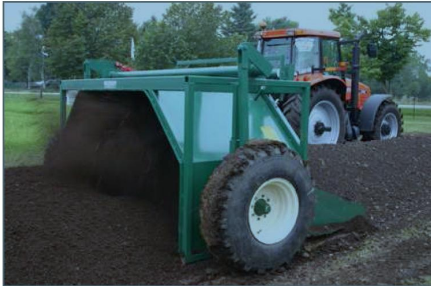
Figura 8. Fotografía de un sistema volteador de compostaje adaptado a tractores. Fuente: Brent Hansen Environmental Bussinness Cosulting And Proyect Managemet LTD.
