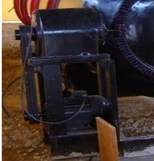
Figura 88. Montaje del motor y las poleas.
