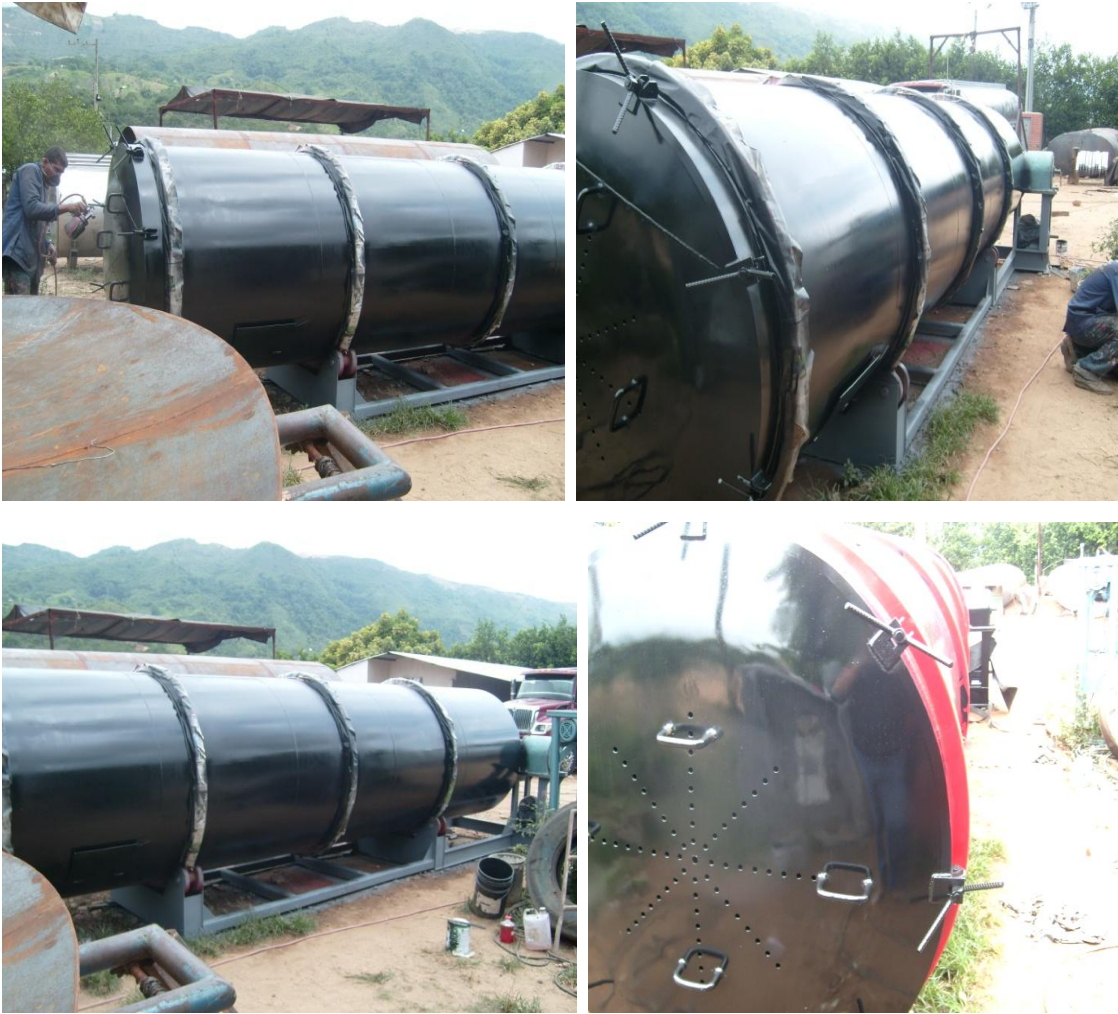
Figura 89. Pintado del tanque.
