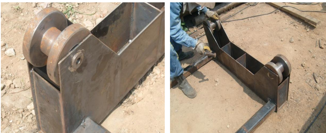
Figura 83. Masas de rotación montadas en las bases del bastidor.
