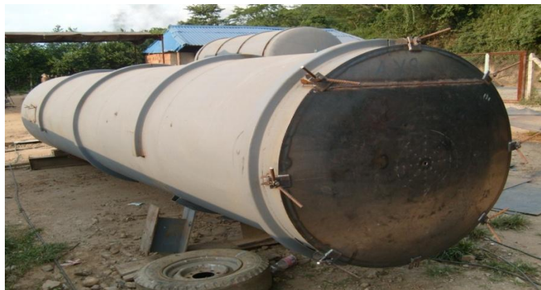
Figura 72. Tapa de descarga montada en el tanque.
