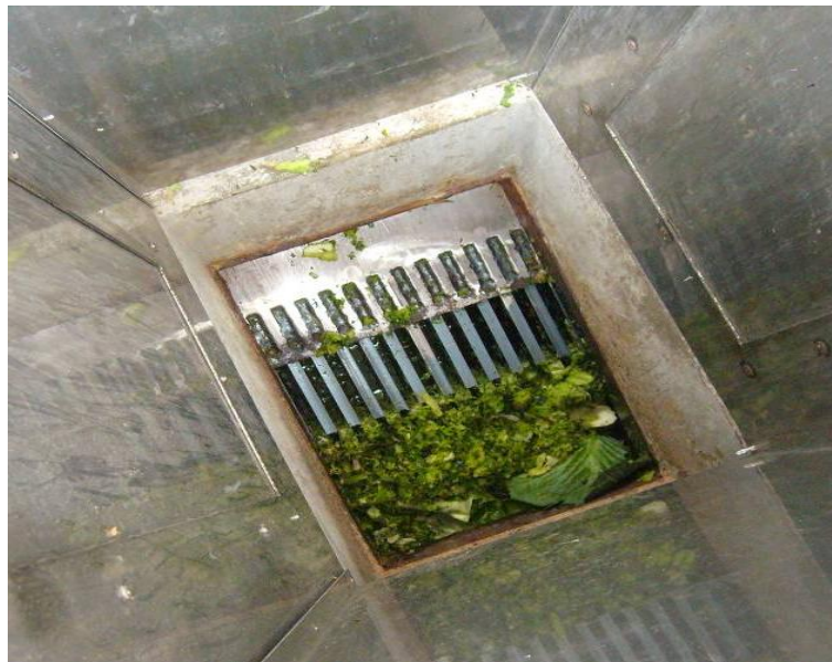
Figura 94. Material en tolva ya triturado.
