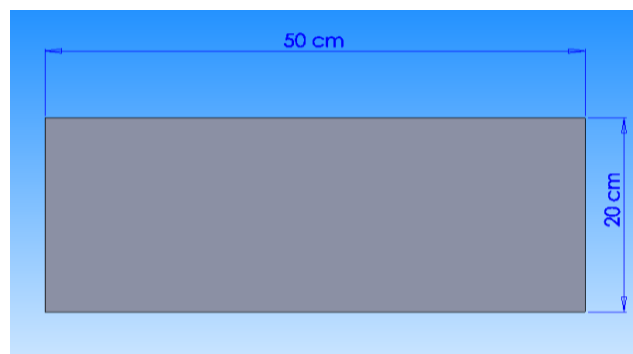
Figura 37. Dimensiones de las aspas lamina HR 3/16.
