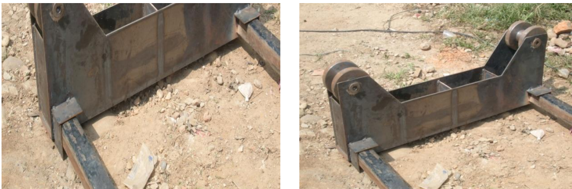
Figura 82. Bases soldadas al marco del bastidor.
