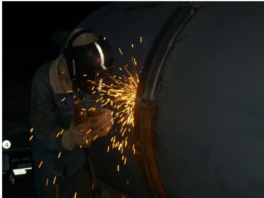
Figura 78. Soldadura de anillo con electrodo revestido.
