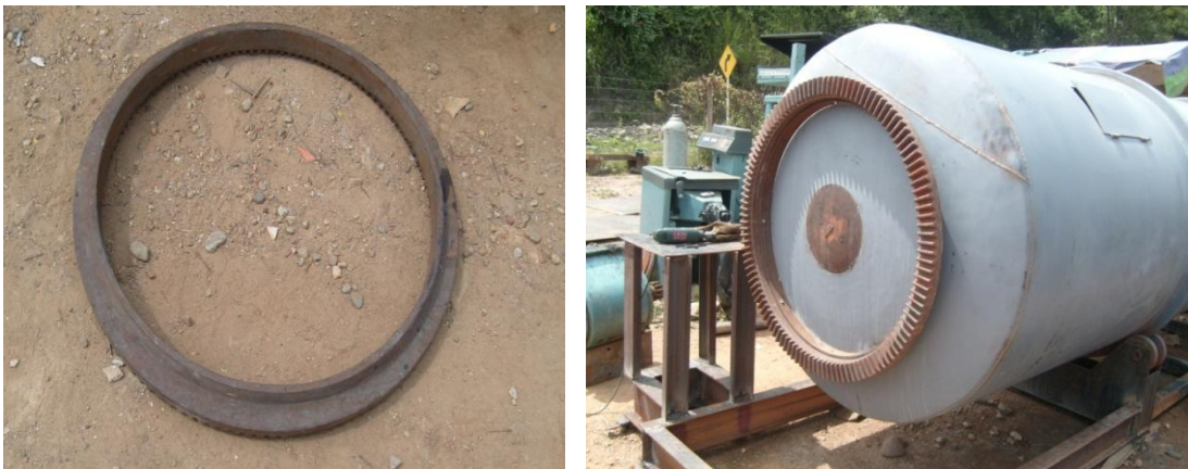
Figura 85. Corona montada en la tapa del tanque.
