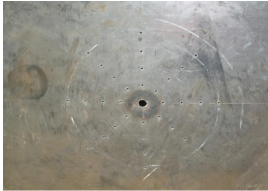
Figura 74. Marcado sobre lámina de parámetros para agujeros de la tapa de descargue
