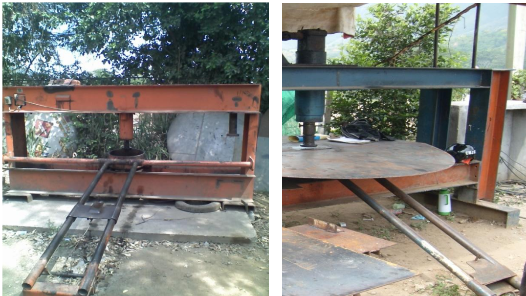
Figura 70. Máquina abombadora y proceso para elaboración de tapas.
