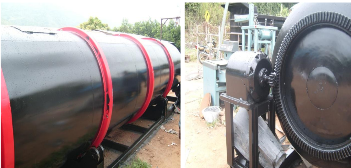
Figura 90. Anillos de rotación pintados de rojo y compuerta de carga con la corana.
