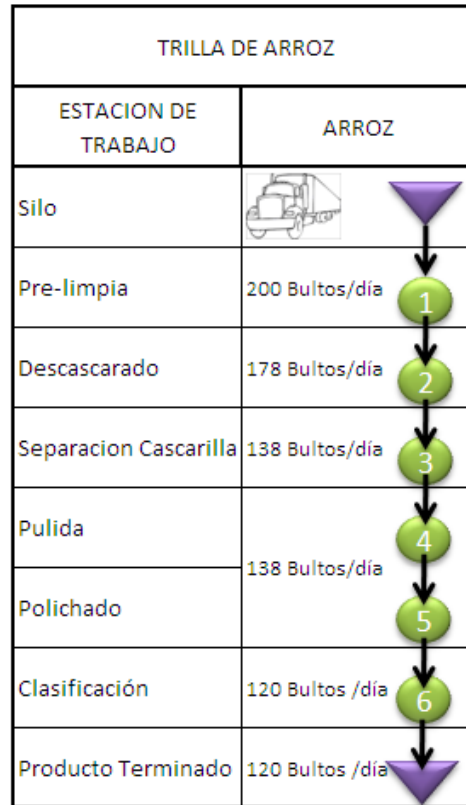
Figura 10. Flujo de materiales para el proceso de Trilla de Arroz
