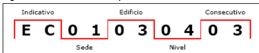
Figura 4: Nueva nomenclatura para elementos constructivos.
