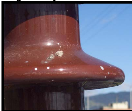
Figura 34. Pasatapas degradado y con contaminantes adheridos, Detalle.
