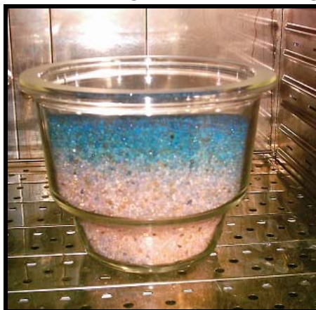
Figura 31. Proceso de regenerado de silicagel en horno.
