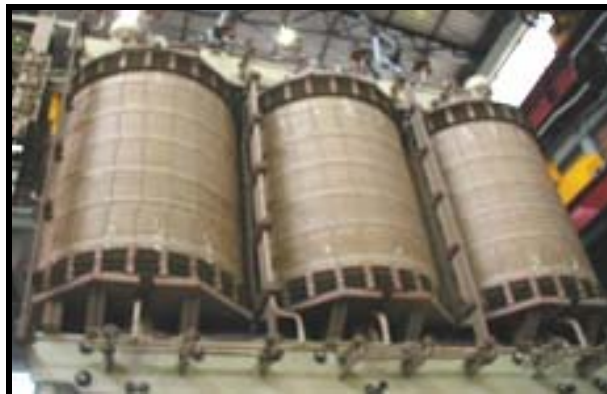
Figura 2. Devanados de transformador de 30 MVA.
