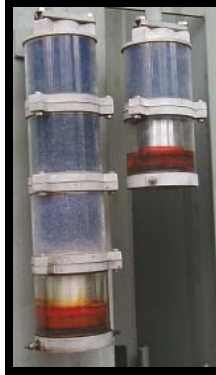
Figura 20. Deshumectador con silicagel y cobalto en estado seco.
