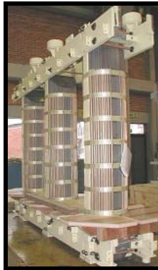
Figura 3. Núcleo de transformador de 30 MVA.
