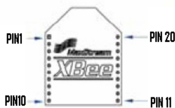
Figura 2.12 Distribución de pines de la plataforma Xbee. Fuente: Adaptado por los autores de Digi, hoja de especificaciones técnicas “Xbee ZNet 2.5”.
