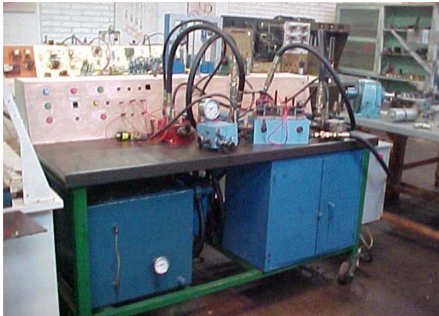
Figura 8. Banco de Bomba doble para prueba de válvula de descarga.
