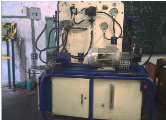
Figura 10. Banco de prueba de bombas.
