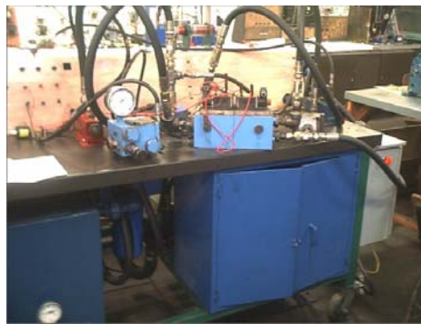
FIGURA 7 Banco de Bomba doble para prueba de válvula de descarga
